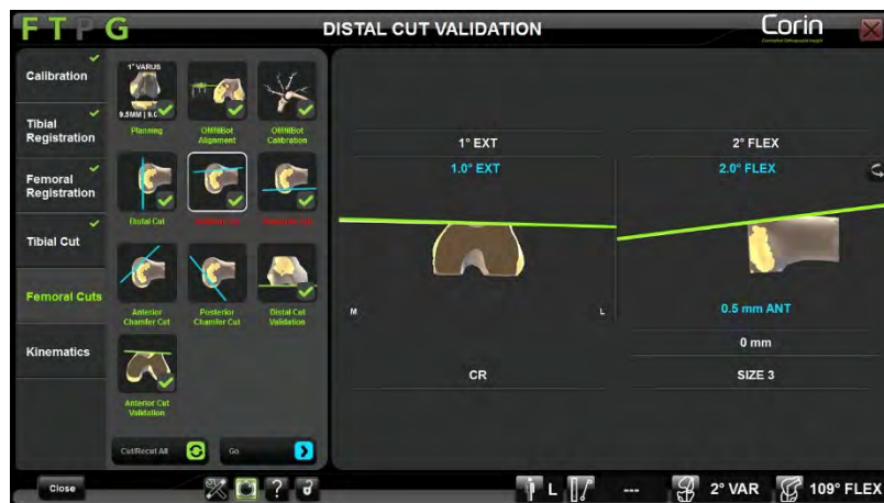
Il Menu si apre automaticamente dopo il taglio distale
